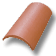
Dachfirst Dim. 46 cm (lunghezza) Gewicht 4,80 kg Bedarf 2,5 Stück/m
